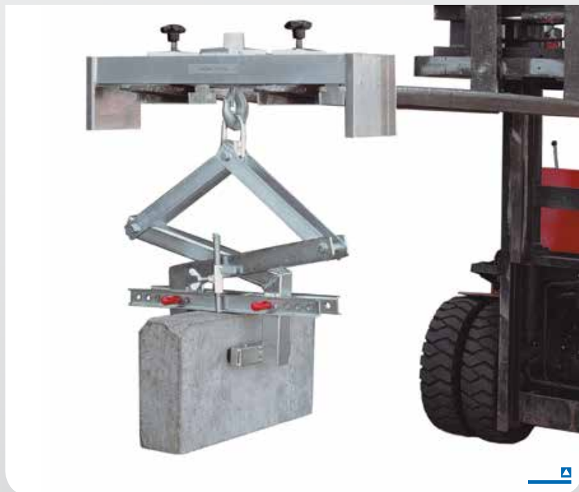
Aluminium heftrucktraverse met tang (niet bij levering inbegrepen)
