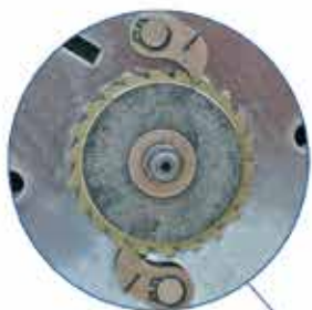
Sicherheitsbremse mit zwei Sperrklinken
